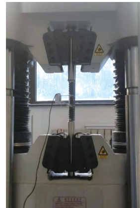
图 1 GFRP 锚杆拉拔试验
