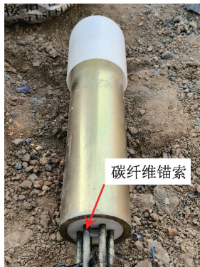
图 6 碳纤维锚索端头部位照片
