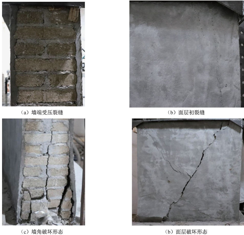
图8 试件 OCB-HDC-2 的失效过程
