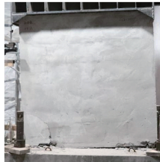
(d) 面层侧破坏形态
