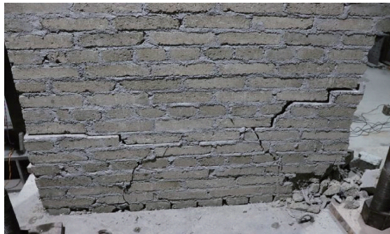
(c) 无面层侧破坏形态
