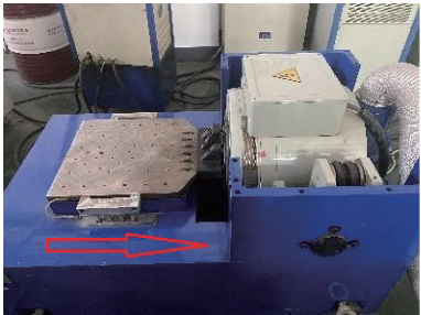
图 2 ES-10 振动试验系统 Fig.2 ES-10 vibration testing system
