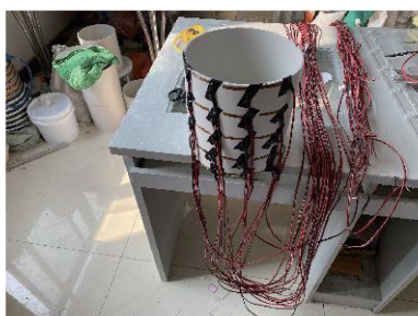
(b) 筒仓形结构测点布置图
