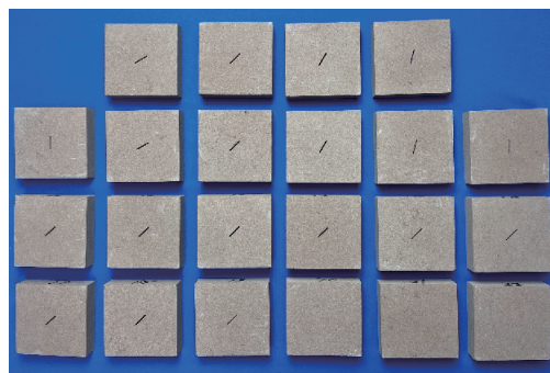
图1 预制单裂隙砂岩试样
