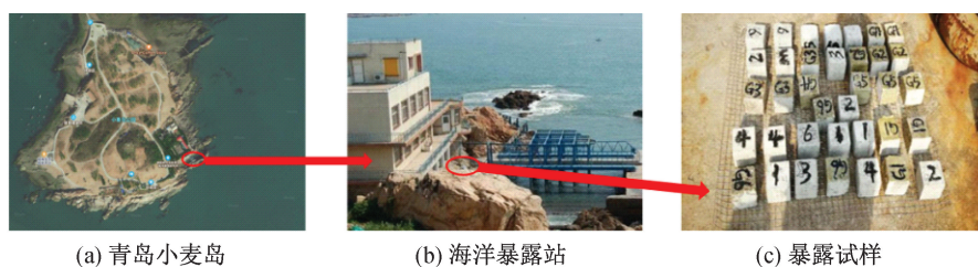
图 2 大气区实海暴露试验
